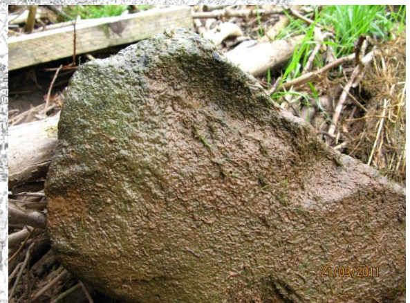
↑ An zahlreichen Prallufeln bilden Wasserschüttsteine eines standortfremden geologischen Ursprungs (Basalt) ein Substrat, das wegen seiner harten und glatten Oberfläche, die kaum infiltriert oder erodiert wird, nicht den natürlichen Gegebenheiten entspricht.
